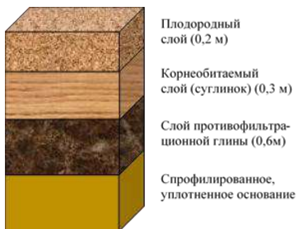
Рисунок 1 – Структура противofильтрационного экрана
